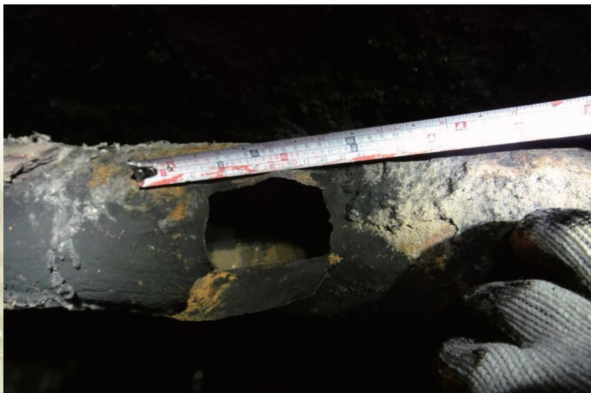
4 吋管破口尺寸約為 4CM×7CM
